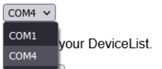
La méthode la plus simple pour déterminer le port COM associer au dongle est de regarder la liste des ports, débrancher le dongle et reregarder la liste. Un port à du disparaître de la liste, rebrancher le dongle et choisissez le port que vous avez trouvé.
